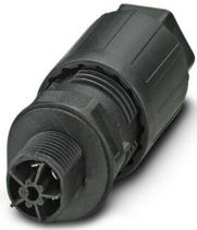
Traversée de paroi, Raccordement QUICKON, nombre de pôles: 4+PE, 690 V, 15 A, noir, avec écrou QUICKON, diamètre extérieur du câble: 9 mm ... 16 mm, filetage de montage: M20, Raccordement par clips (pour clips selon DIN 46247-2)
