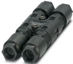
Répartiteur en H QUICKON, noir, 4 pôles + PE, 1,0 mm<sup>2</sup> ... 2,5 mm<sup>2</sup> / 690 V / 20 A, pour diamètre de câble 9 mm ... 16 mm, avec un boulon de fermeture.
