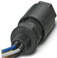
Traversée de paroi, Raccordement QUICKON, nombre de pôles: 4+PE, 690 V, 20 A, noir, avec écrou QUICKON, diamètre extérieur du câble: 9 mm ... 16 mm, filetage de montage: M25, Fils individuels (soudé), 2,5 mm<sup>2</sup>, fils coupés nets, longueur du câble: 0,5 m
