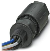
Traversée de paroi, Raccordement QUICKON, nombre de pôles: 4+PE, 690 V, 20 A, noir, avec écrou QUICKON, diamètre extérieur du câble: 9 mm ... 16 mm, filetage de montage: M25, Fils individuels (soudé), 2,5 mm<sup>2</sup>, fils coupés nets, longueur du câble: 1 m
