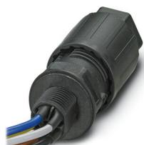
Traversée de paroi, Raccordement QUICKON, nombre de pôles: 4+PE, 690 V, 20 A, noir, avec écrou QUICKON, diamètre extérieur du câble: 9 mm ... 16 mm, filetage de montage: M20, Fils individuels (soudé), 2,5 mm<sup>2</sup>, fils coupés nets, longueur du câble: 0,5 m
