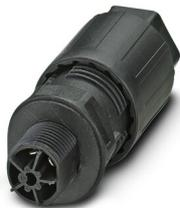
Traversée de paroi QUICKON, noire, 4 pôles + PE, 1,0 mm<sup>2</sup>... 2,5 mm<sup>2</sup> / 690 V / 20 A, avec écrou QUICKON, pour diamètre de câble de 9 mm ... 16 mm, filetage M25 avec 5 contacts à languettes pour clips selon DIN 46247-2
