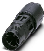
Prolongateur de câble QUICKON, noir, 4 pôles + PE, 1,0 mm<sup>2</sup> ... 2,5 mm<sup>2</sup> / 690 V / 20 A, pour diamètre de câble de 9 mm ... 16 mm.
