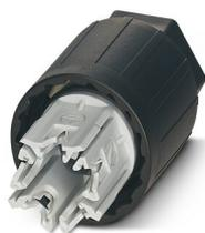
Écrou QUICKON, noir, 4 pôles +PE, 1,0 mm<sup>2</sup> à 2,5 mm<sup>2</sup> / 690 V / 20 A, pour lignes de diamètre 6 mm à 11 mm.
