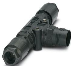
Répartiteur en T QUICKON, noir, 4 pôles + PE, 1,0 mm<sup>2</sup> ... 2,5 mm<sup>2</sup> / 690 V / 20 A, pour diamètre de câble 9 mm ... 16 mm, avec deux écrous Quickon
