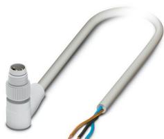
Câble pour capteurs/actionneurs, 3-pôles exempt d'halogène, connecteur mâle coudé M8, détrompage: A, câblé avec déconnecté, sur extrémité libre, longueur de câble: 5 m, Conception hygiénique, avec molette plastique
