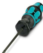
Tournevis dynamométrique, couple de serrage pré-réglé de 0,2Nm et entraînement hexagonal de 4 mm pour connecteur M8
