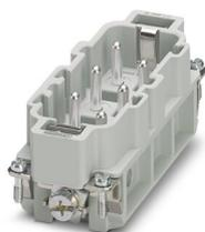
Élément de contact, nombre de pôles: 6+PE, taille: B16, nombre de raccordements par pôle: 1, Mâle, Raccordement vissé, 400 V/690 V, 41 A, 0,5 mm<sup>2</sup> ... 6 mm<sup>2</sup>, application: Puissance
