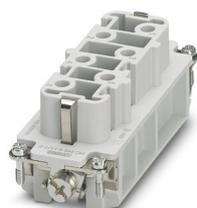
Élément de contact, nombre de pôles: 6+PE, taille: B16, nombre de raccordements par pôle: 1, Connecteur femelle, Raccordement vissé, 400 V/690 V, 41 A, 0,5 mm<sup>2</sup> ... 6 mm<sup>2</sup>, application: Puissance
