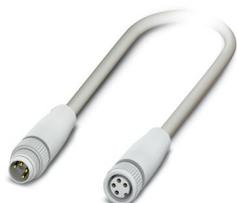
Câble pour capteurs/actionneurs, 4-pôles exempt d'halogène, connecteur mâle droit M8, détrompage: A, câblé avec déconnecté, sur Connecteur femelle droit M8, longueur de câble: 1,5 m, Conception hygiénique, avec molette plastique
