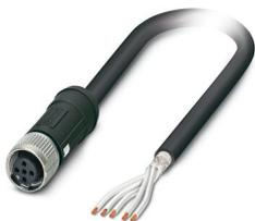
Câble pour capteurs/actionneurs, 5-pôles, Type de câble variable, blindé, extrémité libre, sur Connecteur femelle droit M12, détrompage: A SPEEDCONNEC, longueur de câble: Longueur au choix (0,2... 40,0 m), pour application ferroviaires
