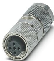
Connecteur, Universel, 5-pôles, blindé, connecteur femelle droit M12, A, Raccordement à sertir, matériau de la molette: Zinc moulé sous pression, étamé, diamètre extérieur du câble 4,5 mm ... 7,5 mm, sans contacts à sertir
