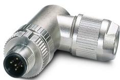
Connecteur, Universel, 5-pôles, blindé, connecteur mâle coudé M12, A, Raccordement à ressort Push-Lock, matériau de la molette: Zinc moulé sous pression, nickelé, diamètre extérieur du câble 4 mm ... 8 mm
