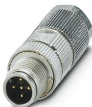
Connecteur, Universel, 5-pôles, blindé, connecteur mâle droit M12, A, Raccordement à sertir, matériau de la molette: Zinc moulé sous pression, étamé, diamètre extérieur du câble 4,5 mm ... 7,5 mm, sans contacts à sertir
