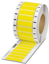
Gaine thermorétractable, Rouleau, jaune, vierge, repérable avec : THERMOMARK E.300 (D)/600 (D), THERMOMARK ROLLMASTER 300/600, THERMOMARK ROLL X1, THERMOMARK ROLL, THERMOMARK ROLL 2.0, THERMOMARK W, THERMOMARK X1.2, non perforé, type de montage: enfilage, plage de diamètre de câble: 4,8 ... 9,5 mm, surface utile: 60 x 16 mm, Nombre d'étiquettes: 500
