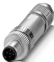
Connecteur, Universel, 5-pôles, blindé, connecteur mâle droit M12, A, Raccordement à ressort Push-Lock, matériau de la molette: Zinc moulé sous pression, nickelé, diamètre extérieur du câble 4 mm ... 8 mm
