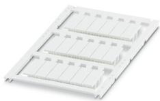
Repérage des conducteur, Planche, blanc, vierge, repérable avec : TOPMARK NEO, LASER TOPMARK, BLUEMARK ID COLOR, BLUEMARK ID, BLUEMARK CLED, THERMOMARK PRIME, THERMOMARK CARD 2.0, THERMOMARK CARD, type de montage: clipsage, plage de diamètre de câble: 4,7 ... 5,4 mm, surface utile: 23 x 8 mm, Nombre d'étiquettes: 18
