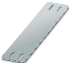
Repères pour câble, Plaque d'aluminium, coloris alu, vierge, repérable avec : BLUEMARK ID COLOR, BLUEMARK ID, BLUEMARK CLED, type de montage: Montage de serre-câbles, diamètre du câble: > 4,6 mm, surface utile: 40 x 15 mm
