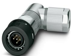
Connecteur, Universel, 5-pôles, blindé, connecteur mâle coudé M12 Push-Pull, A, Raccordement à sertir, matériau de la molette: PA 6.6, diamètre extérieur du câble 4,5 mm ... 7,5 mm, sans contacts à sertir
