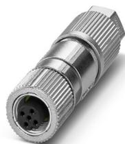
Connecteur, Universel, 5-pôles, exempt d'halogène, blindé, connecteur femelle droit M12, A, Raccordement autodénudant, matériau de la molette: Zinc moulé sous pression, nickelé, diamètre extérieur du câble 5 mm ... 9,7 mm
