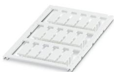
Repérage des conducteur, Plaque, blanc, vierge, repérable avec : TOPMARK NEO, LASER TOPMARK, BLUEMARK ID COLOR, BLUEMARK ID, BLUEMARK CLED, THERMOMARK PRIME, THERMOMARK CARD 2.0, THERMOMARK CARD, type de montage: clipsage, plage de diamètre de câble: 6,8 ... 7,5 mm, surface utile: 23 x 8 mm, Nombre d'étiquettes: 15
