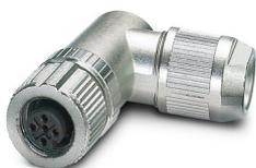
Connecteur, Universel, 5-pôles, blindé, connecteur femelle coudé M12, A, Raccordement à ressort Push-Lock, matériau de la molette: Zinc moulé sous pression, nickelé, diamètre extérieur du câble 4 mm ... 8 mm
