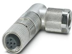
Connecteur, Universel, 5-pôles, blindé, connecteur femelle coudé M12, A, Raccordement à sertir, matériau de la molette: Zinc moulé sous pression, étamé, diamètre extérieur du câble 4,5 mm ... 7,5 mm, sans contacts à sertir
