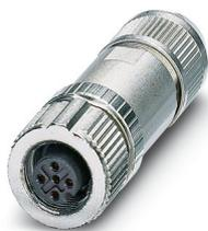
Connecteur, Universel, 5-pôles, blindé, connecteur femelle droit M12, A, Raccordement à ressort Push-Lock, matériau de la molette: Zinc moulé sous pression, nickelé, diamètre extérieur du câble 4 mm ... 8 mm
