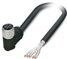
Câble pour capteurs/actionneurs, 5-pôles, Type de câble variable, blindé, extrémité libre, sur Connecteur femelle coudé M12, détrompage: A SPEEDCONNEC, longueur de câble: Longueur au choix (0,2... 40,0 m), pour application ferroviaires
