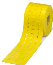
Repères pour câble, Rouleau, jaune, vierge, repérable avec : THERMOMARK E. 300 (D)/600 (D), THERMOMARK ROLL 2.0, THERMOMARK ROLL, THERMOMARK ROLL X1, THERMOMARK ROLLMASTER 300/600, THERMOMARK X1.2, type de montage: Montage de serre-câbles, diamètre du câble:  $\geq 6$  mm, surface utile: 40 x 12 mm, Nombre d'étiquettes: 1000
