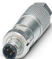
Connecteur de données, Ethernet CAT5 (100 Mbit/s), 4-pôles, exempt d'halogène, blindé, connecteur mâle droit M12, D, Raccordement autodénudant, matériau de la molette: Zinc moulé sous pression, nickelé, diamètre extérieur du câble 5 mm ... 9,7 mm
