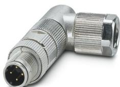
Connecteur de données, PROFINET CAT5 (100 Mbit/s), 4-pôles, blindé, connecteur mâle coudé M12, D, Raccordement à sertir, matériau de la molette: Zinc moulé sous pression, étamé, diamètre extérieur du câble 4,5 mm ... 7,5 mm, sans contacts à sertir
