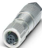
Connecteur de données, PROFINET CAT5 (100 Mbit/s), 4-pôles, exempt d'halogène, blindé, connecteur femelle droit M12, D, Raccordement autodénudant, matériau de la molette: Zinc moulé sous pression, nickelé, diamètre extérieur du câble 5 mm ... 9,7 mm
