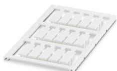
Repérage des conducteur, Planche, blanc, vierge, repérable avec : TOPMARK NEO, LASER TOPMARK, BLUEMARK ID COLOR, BLUEMARK ID, BLUEMARK CLED, THERMOMARK PRIME, THERMOMARK CARD 2.0, THERMOMARK CARD, type de montage: clipsage, plage de diamètre de câble: 6,1 ... 6,8 mm, surface utile: 23 x 8 mm, Nombre d'étiquettes: 15
