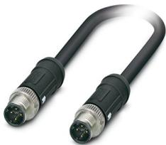
Câble de réseau, PROFINET CAT5 (100 Mbit/s), Ethernet CAT5 (100 Mbit/s), 4-pôles, Type de câble variable, blindé, connecteur mâle droit M12, détrompage: D SPEEDCONNEC / IP65, sur connecteur mâle droit M12, détrompage: D SPEEDCONNEC / IP65, longueur de câble: Longueur au choix (0,2... 40,0 m), pour application ferroviaires
