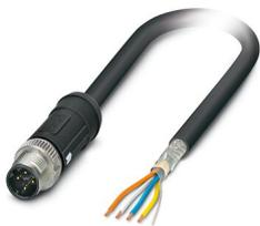
Câble de réseau, PROFINET CAT5 (100 Mbit/s), Ethernet CAT5 (100 Mbit/s), 4-pôles, Type de câble variable, blindé, connecteur mâle droit M12, détrompage: D SPEEDCONNEC / IP65, sur extrémité libre, longueur de câble: Longueur au choix (0,2... 40,0 m), pour application ferroviaires
