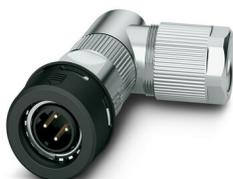
Connecteur de données, PROFINET CAT5 (100 Mbit/s), 4-pôles, blindé, connecteur mâle coudé M12 Push-Pull, D, Raccordement à sertir, matériau de la molette: PA 6.6, diamètre extérieur du câble 4,5 mm ... 7,5 mm, sans contacts à sertir
