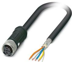
Câble de réseau, PROFINET CAT5 (100 Mbit/s), Ethernet CAT5 (100 Mbit/s), 4-pôles, Type de câble variable, blindé, extrémité libre, sur Connecteur femelle droit M12, détrompage: D SPEEDCONNEC / IP65, longueur de câble: Longueur au choix (0,2... 40,0 m), pour application ferroviaires
