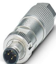
Connecteur de données, PROFINET CAT5 (100 Mbit/s), 4-pôles, exempt d'halogène, blindé, connecteur mâle droit M12, D, Raccordement autodénudant, matériau de la molette: Zinc moulé sous pression, nickelé, diamètre extérieur du câble 5 mm ... 9,7 mm
