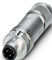
Connecteur, PROFINET CAT5 (100 Mbit/s), 4-pôles, blindé, connecteur mâle droit M12, D, Raccordement à ressort Push-Lock, matériau de la molette: Zinc moulé sous pression, nickelé, diamètre extérieur du câble 4 mm ... 8 mm
