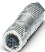
Connecteur de données, Ethernet CAT5 (100 Mbit/s), 4-pôles, exempt d'halogène, blindé, connecteur femelle droit M12, D, Raccordement autodénudant, matériau de la molette: Zinc moulé sous pression, nickelé, diamètre extérieur du câble 5 mm ... 9,7 mm
