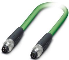
Câble de réseau, Ethernet (100 Mbit/s), PROFINET (100 Mbit/s), EtherCAT<sup>®</sup> (100 Mbit/s), 4-pôles, Type de câble variable, blindé, connecteur mâle droit M8, détrompage: A / IP67, sur connecteur mâle droit M8, détrompage: A / IP67, longueur de câble: Longueur au choix (0,2... 40,0 m)
