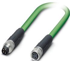
Câble de réseau, Ethernet (100 Mbit/s), PROFINET (100 Mbit/s), EtherCAT® (100 Mbit/s), 4-pôles, Type de câble variable, blindé, connecteur mâle droit M8, détrompage: A / IP67, sur Connecteur femelle droit M8, détrompage: A / IP67, longueur de câble: Longueur au choix (0,2... 40,0 m)
