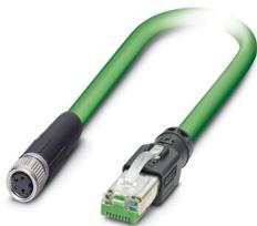
Câble de réseau, Ethernet (100 Mbit/s), PROFINET (100 Mbit/s), EtherCAT® (100 Mbit/s), 4-pôles, Type de câble variable, blindé, connecteur mâle droit RJ45 / IP20, sur Connecteur femelle droit M8, détrompage: A / IP67, longueur de câble: Longueur au choix (0,2... 40,0 m)
