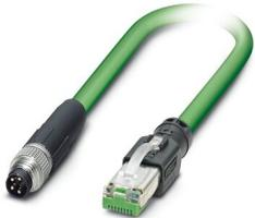
Câble de réseau, Ethernet (100 Mbit/s), PROFINET (100 Mbit/s), EtherCAT® (100 Mbit/s), 4-pôles, blindé, connecteur mâle droit M8, détrompage: A / IP67, sur connecteur mâle droit RJ45 / IP20, longueur de câble: 1 m
