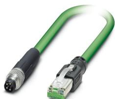
Câble de réseau, Ethernet (100 Mbit/s), PROFINET (100 Mbit/s), EtherCAT® (100 Mbit/s), 4-pôles, blindé, connecteur mâle droit M8, détrompage: A / IP67, sur connecteur mâle droit RJ45 / IP20, longueur de câble: 10 m
