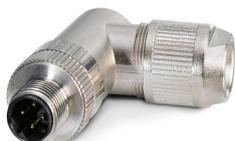
Connecteur de données, Ethernet CAT5 (100 Mbit/s), 4-pôles, blindé, connecteur mâle coudé M12, D, Raccordement autodénudant, matériau de la molette: Laiton, nickelé, diamètre extérieur du câble 4 mm ... 8 mm
