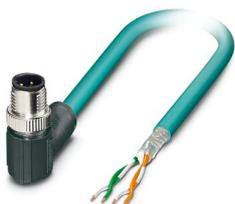
Câble de réseau, Ethernet CAT5 (100 Mbit/s), 4-pôles, blindé, connecteur mâle coudé M12, détrompage: D SPEEDCONNEC / IP67, sur extrémité libre, longueur de câble: Longueur au choix (0,2... 40,0 m)
