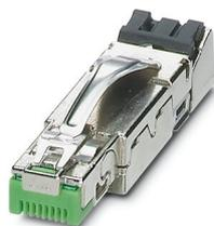
Connecteur RJ45, type: RJ45, indice de protection: IP20, nombre de pôles: 8, 1 Gbit/s, CAT5, matériau: Métal, type de raccordement: Raccordement autodénudant, section raccordable: AWG 26- 24, sortie du câble: droit, coloris: vert, Ethernet
