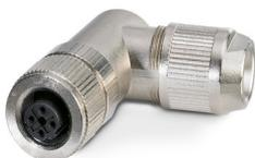
Connecteur de données, Ethernet CAT5 (100 Mbit/s), 4-pôles, blindé, connecteur femelle coudé M12, D, Raccordement autodénudant, matériau de la molette: Laiton, nickelé, diamètre extérieur du câble 4 mm ... 8 mm
