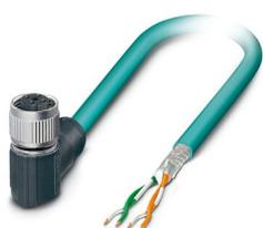
Câble de réseau, Ethernet CAT5 (100 Mbit/s), 4-pôles, blindé, extrémité libre, sur Connecteur femelle coudé M12, détrompage: D SPEEDCONNEC / IP67, longueur de câble: Longueur au choix (0,2... 40,0 m)
