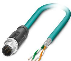
Câble de réseau, Ethernet CAT5 (100 Mbit/s), 4-pôles, blindé, connecteur mâle droit M12, détrompage: D SPEEDCONNEC / IP67, sur extrémité libre, longueur de câble: Longueur au choix (0,2... 40,0 m)
