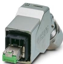
Connecteur RJ45, indice de protection: IP65/IP67, nombre de pôles: 8, 1 Gbit/s, CAT5, matériau: Métal, type de raccordement: Raccordement autodénudant IDC, section raccordable: AWG 26- 24, sortie du câble: coudé, Ethernet
