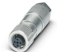
Connecteur de données, Ethernet CAT5 (100 Mbit/s), 4-pôles, exempt d'halogène, blindé, connecteur femelle droit M12, D, Raccordement autodénudant, matériau de la molette: Zinc moulé sous pression, nickelé, diamètre extérieur du câble 5 mm ... 9,7 mm
