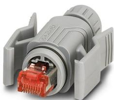
Connecteur RJ45, type: RJ45, indice de protection: IP67, nombre de pôles: 8, 1 Gbit/s, CAT6, matériau: Plastique, type de raccordement: Raccordement à sertir, section raccordable: AWG 27- 24, sortie du câble: droit, coloris: gris, Ethernet / PROFINET
