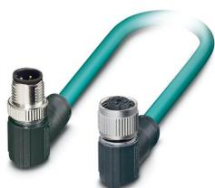
Câble de réseau, Ethernet CAT5 (100 Mbit/s), 4-pôles, blindé, connecteur mâle coudé M12, détrompage: D SPEEDCONNEC / IP67, sur Connecteur femelle coudé M12, détrompage: D SPEEDCONNEC / IP67, longueur de câble: Longueur au choix (0,2... 40,0 m)
