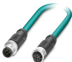
Câble de réseau, Ethernet CAT5 (100 Mbit/s), 4-pôles, blindé (Advanced Shielding Technology), connecteur mâle droit M12, détrompage: D / IP67, sur Connecteur femelle droit M12, détrompage: D / IP67, longueur de câble: 10 m
