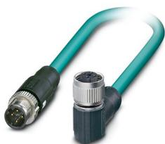
Câble de réseau, Ethernet CAT5 (100 Mbit/s), 4-pôles, blindé, connecteur mâle droit M12, détrompage: D SPEEDCONNEC / IP67, sur Connecteur femelle coudé M12, détrompage: D SPEEDCONNEC / IP67, longueur de câble: Longueur au choix (0,2... 40,0 m)
