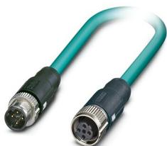
Câble de réseau, Ethernet CAT5 (100 Mbit/s), 4-pôles, blindé, connecteur mâle droit M12, détrompage: D SPEEDCONNEC / IP67, sur Connecteur femelle droit M12, détrompage: D SPEEDCONNEC / IP67, longueur de câble: Longueur au choix (0,2... 40,0 m)
