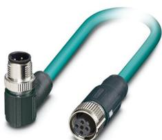
Câble de réseau, Ethernet CAT5 (100 Mbit/s), 4-pôles, blindé, connecteur mâle coudé M12, détrompage: D SPEEDCONNEC / IP67, sur Connecteur femelle droit M12, détrompage: D SPEEDCONNEC / IP67, longueur de câble: Longueur au choix (0,2... 40,0 m)
