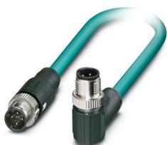
Câble de réseau, Ethernet CAT5 (100 Mbit/s), 4-pôles, blindé, connecteur mâle droit M12, détrompage: D SPEEDCONNEC / IP67, sur connecteur mâle coudé M12, détrompage: D SPEEDCONNEC / IP67, longueur de câble: Longueur au choix (0,2... 40,0 m)
