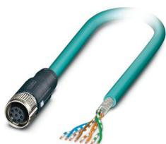
Câble de réseau, Ethernet CAT5 (1 Gbit/s), 8-pôles, Type de câble variable, blindé, extrémité libre, sur Connecteur femelle droit M12, détrompage: A SPEEDCONNEC / IP67, longueur de câble: Longueur au choix (0,2... 40,0 m)
