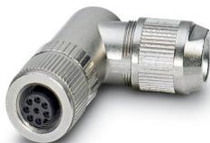
Connecteur de données, Ethernet CAT5 (1 Gbit/s), 8-pôles, blindé, connecteur femelle coudé M12, A, Raccordement autodénudant, matériau de la molette: Laiton, nickelé, diamètre extérieur du câble 4 mm ... 8 mm
