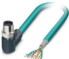
Câble de réseau, Ethernet CAT5 (1 Gbit/s), 8-pôles, Type de câble variable, blindé, connecteur mâle coudé M12, détrompage: A SPEEDCONNEC / IP67, sur extrémité libre, longueur de câble: Longueur au choix (0,2... 40,0 m)
