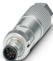
Connecteur de données, Ethernet CAT5 (1 Gbit/s), 8-pôles, exempt d'halogène, blindé, connecteur mâle droit M12, A, Raccordement autodénudant, matériau de la molette: Zinc moulé sous pression, nickelé, diamètre extérieur du câble 5 mm ... 9,7 mm
