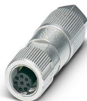
Connecteur de données, Ethernet CAT5 (1 Gbit/s), 8-pôles, exempt d'halogène, blindé, connecteur femelle droit M12, A, Raccordement autodénudant, matériau de la molette: Zinc moulé sous pression, nickelé, diamètre extérieur du câble 5 mm ... 9,7 mm
