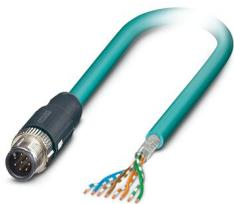
Câble de réseau, Ethernet CAT5 (1 Gbit/s), 8-pôles, Type de câble variable, blindé, connecteur mâle droit M12, détrompage: A SPEEDCONNEC / IP67, sur extrémité libre, longueur de câble: Longueur au choix (0,2... 40,0 m)
