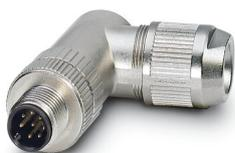
Connecteur de données, Ethernet CAT5 (1 Gbit/s), 8-pôles, blindé, connecteur mâle coudé M12, A, Raccordement autodénudant, matériau de la molette: Laiton, nickelé, diamètre extérieur du câble 4 mm ... 8 mm
