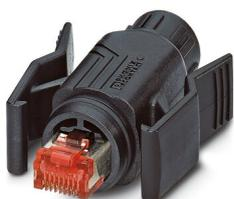
Connecteur RJ45, type: RJ45, indice de protection: IP67, nombre de pôles: 8, 1 Gbit/s, CAT6, matériau: Plastique, type de raccordement: Raccordement à sertir, section raccordable: AWG 24- 27, sortie du câble: droit, coloris: noir, Ethernet / PROFINET
