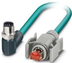
Câble de réseau, Ethernet CAT5 (1 Gbit/s), 8-pôles, Type de câble variable, blindé, connecteur mâle coudé M12, détrompage: A SPEEDCONNEC / IP67, sur connecteur mâle droit RJ45 Verrouillage à clip / IP20, longueur de câble: Longueur au choix (0,2... 40,0 m)
