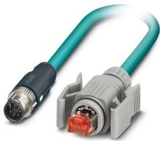
Câble de réseau, Ethernet CAT5 (1 Gbit/s), 8-pôles, Type de câble variable, blindé, connecteur mâle droit M12, détrompage: A SPEEDCONNEC / IP67, sur connecteur mâle droit RJ45 Verrouillage à clip / IP20, longueur de câble: Longueur au choix (0,2... 40,0 m)
