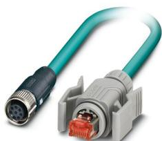
Câble de réseau, Ethernet CAT5 (1 Gbit/s), 8-pôles, Type de câble variable, blindé, Connecteur femelle droit M12 SPEEDCONNec / IP67, sur connecteur mâle droit RJ45 Verrouillage à clip / IP20, longueur de câble: Longueur au choix (0,2... 40,0 m)
