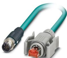
Câble de réseau, Ethernet CAT5 (1 Gbit/s), 8-pôles, blindé, connecteur mâle droit M12, détrompage: A SPEEDCONNEC / IP67, sur connecteur mâle droit RJ45 Verrouillage à clip / IP67, longueur de câble: 5 m
