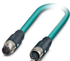
Câble de réseau, Ethernet CAT5 (1 Gbit/s), 8-pôles, Type de câble variable, blindé, connecteur mâle droit M12, détrompage: A SPEEDCONNEC / IP67, sur Connecteur femelle droit M12, détrompage: A SPEEDCONNEC / IP67, longueur de câble: Longueur au choix (0,2... 40,0 m)
