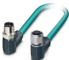
Câble de réseau, Ethernet CAT5 (1 Gbit/s), 8-pôles, Type de câble variable, blindé, connecteur mâle coudé M12, détrompage: A SPEEDCONNEX / IP67, sur Connecteur femelle coudé M12, détrompage: A SPEEDCONNEX / IP67, longueur de câble: Longueur au choix (0,2... 40,0 m)
