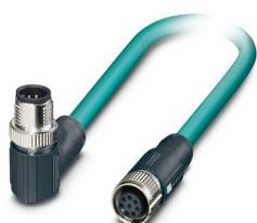
Câble de réseau, Ethernet CAT5 (1 Gbit/s), 8-pôles, Type de câble variable, blindé, connecteur mâle coudé M12, détrompage: A SPEEDCONNEC / IP67, sur Connecteur femelle droit M12, détrompage: A SPEEDCONNEC / IP67, longueur de câble: Longueur au choix (0,2... 40,0 m)
