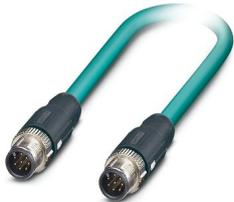
Câble de réseau, Ethernet CAT5 (1 Gbit/s), 8-pôles, blindé, connecteur mâle droit M12, détrompage: A SPEEDCONNEC / IP67, sur connecteur mâle droit M12, détrompage: A SPEEDCONNEC / IP67, longueur de câble: 10 m
