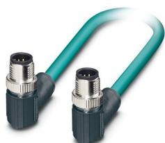
Câble de réseau, Ethernet CAT5 (1 Gbit/s), 8-pôles, Type de câble variable, blindé, connecteur mâle coudé M12, détrompage: A SPEEDCONNEC / IP67, sur connecteur mâle coudé M12, détrompage: A SPEEDCONNEC / IP67, longueur de câble: Longueur au choix (0,2... 40,0 m)
