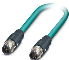
Câble de réseau, Ethernet CAT5 (1 Gbit/s), 8-pôles, Type de câble variable, blindé, connecteur mâle droit M12, détrompage: A SPEEDCONNEC / IP67, sur connecteur mâle droit M12, détrompage: A SPEEDCONNEC / IP67, longueur de câble: Longueur au choix (0,2... 40,0 m)
