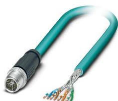
Câble de réseau, Ethernet CAT6<sub>A</sub> (10 Gbit/s), CC-Link IE CAT6<sub>A</sub> (10 Gbit/s), 8-pôles exempt d'halogène, blindé (Advanced Shielding Technology), connecteur mâle droit M12, détrompage: X / IP67, sur extrémité libre, détrompage: X, longueur de câble: 2 m
