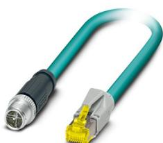
Câble de réseau, Ethernet CAT6<sub>A</sub> (10 Gbit/s), CC-Link IE CAT6<sub>A</sub> (10 Gbit/s), 8-pôles, Type de câble variable, blindé (Advanced Shielding Technology), connecteur mâle droit M12, détrompage: X / IP67, sur connecteur mâle droit RJ45 / IP20, longueur de câble: Longueur au choix (0,2... 40,0 m)
