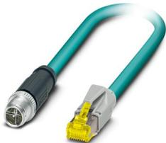
Câble de réseau, Ethernet CAT6<sub>A</sub> (10 Gbit/s), CC-Link IE CAT6<sub>A</sub> (10 Gbit/s), 8-pôles exempt d'halogène, blindé (Advanced Shielding Technology), connecteur mâle droit M12, détrompage: X / IP67, sur connecteur mâle droit RJ45 / IP20, longueur de câble: 5 m
