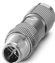
Connecteur de données, Ethernet CAT6<sub>A</sub> (10 Gbit/s), 8-pôles, blindé, connecteur mâle droit M12 SPEEDCONNEC, X, Raccordement rapide Piercecon<sup>®</sup>, matériau de la molette: Zinc moulé sous pression, nickelé, diamètre extérieur du câble 4 mm ... 8 mm
