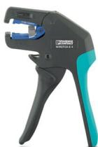
Outil à dénuder, pour câbles et conducteurs (spécialement aussi pour isolants en caoutchouc et silicone) de 0,1 - 4 mm<sup>2</sup>, réglage automatique, longueur à dénuder jusqu'à 18 mm, capacité de sectionnement jusqu'à 10 mm<sup>2</sup> flexible/ 1,5 mm<sup>2</sup> rigide, couteau de dénudage remplaçable
