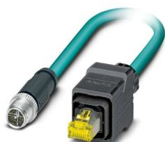
Câble de réseau, Ethernet CAT6<sub>A</sub> (10 Gbit/s), CC-Link IE CAT6<sub>A</sub> (10 Gbit/s), 8-pôles exempt d'halogène, blindé (Advanced Shielding Technology), connecteur mâle droit M12, détrompage: X SPEEDCONNEC / IP67, sur connecteur mâle droit RJ45 Push-Pull / IP67, longueur de câble: 1 m
