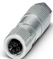
Connecteur de données, Ethernet CAT6<sub>A</sub> (10 Gbit/s), 8-pôles, exempt d'halogène, blindé, connecteur femelle droit M12, X, Raccordement autodénudant, matériau de la molette: Zinc moulé sous pression, nickelé, diamètre extérieur du câble 5 mm ... 9,7 mm
