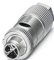
Connecteur de données, Ethernet CAT6<sub>A</sub> (10 Gbit/s), 8-pôles, exempt d'halogène, blindé, connecteur mâle droit M12, X, Raccordement autodénudant, matériau de la molette: Zinc moulé sous pression, nickelé, diamètre extérieur du câble 5 mm ... 9,7 mm
