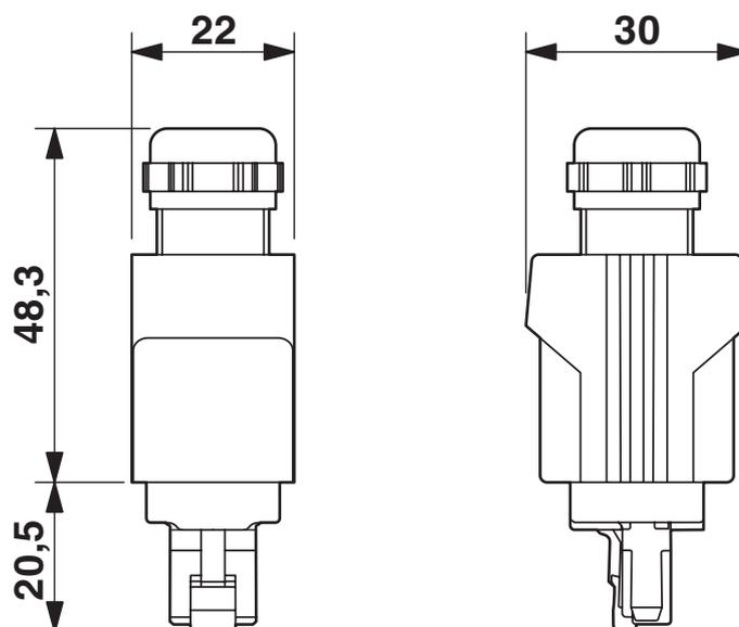
Connecteur mâle RJ45 Push-Pull, IP67
