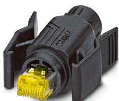
Connecteur RJ45, type: RJ45, indice de protection: IP67, nombre de pôles: 8, 10 Gbit/s, CAT6<sub>A</sub>, matériau: Plastique, type de raccordement: Raccordement à sertir, section raccordable: AWG 24- 27, sortie du câble: droit, coloris: noir, Ethernet / PROFINET
