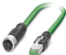
Câble de réseau, PROFINET CAT5 (100 Mbit/s), EtherCAT® CAT5 (100 Mbit/s), 4-pôles, Type de câble variable, blindé, Connecteur femelle droit M12, détrompage: D SPEEDCONNEC / IP67, sur connecteur mâle droit RJ45 / IP20, longueur de câble: Longueur au choix (0,2... 40,0 m)
