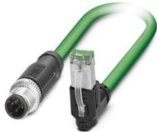
Câble de réseau, PROFINET CAT5 (100 Mbit/s), EtherCAT® CAT5 (100 Mbit/s), 4-pôles, blindé (Advanced Shielding Technology), connecteur mâle droit M12, détrompage: D / IP67, sur connecteur mâle coudé RJ45 / IP20, longueur de câble: 2 m
