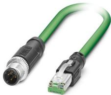
Câble de réseau, PROFINET CAT5 (100 Mbit/s), EtherCAT® CAT5 (100 Mbit/s), 4-pôles, Type de câble variable, blindé, connecteur mâle droit M12, détrompage: D SPEEDCONNEX / IP67, sur connecteur mâle droit RJ45 / IP20, longueur de câble: Longueur au choix (0,2... 40,0 m)
