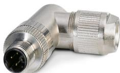
Connecteur de données, PROFINET CAT5 (100 Mbit/s), 4-pôles, blindé, connecteur mâle coudé M12, D, Raccordement autodénudant, matériau de la molette: Laiton, nickelé, diamètre extérieur du câble 4 mm ... 8 mm
