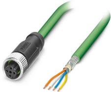
Câble de réseau, PROFINET CAT5 (100 Mbit/s), EtherCAT® CAT5 (100 Mbit/s), 4-pôles, blindé (Advanced Shielding Technology), extrémité libre, sur Connecteur femelle droit M12, détrompage: D / IP67, longueur de câble: 10 m
