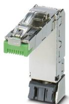
Connecteur RJ45, type: RJ45, indice de protection: IP20, nombre de pôles: 8, 1 Gbit/s, CAT5, matériau: Métal, type de raccordement: Raccordement autodénudant, section raccordable: AWG 23- 22, sortie du câble: coudé, Ethernet / PROFINET
