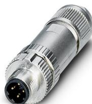
Connecteur, PROFINET CAT5 (100 Mbit/s), 4-pôles, blindé, connecteur mâle droit M12, D, Raccordement à ressort Push-Lock, matériau de la molette: Zinc moulé sous pression, nickelé, diamètre extérieur du câble 4 mm ... 8 mm
