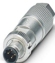
Connecteur de données, PROFINET CAT5 (100 Mbit/s), 4-pôles, exempt d'halogène, blindé, connecteur mâle droit M12, D, Raccordement autodénudant, matériau de la molette: Zinc moulé sous pression, nickelé, diamètre extérieur du câble 5 mm ... 9,7 mm
