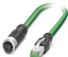
Câble de réseau, PROFINET CAT5 (100 Mbit/s), EtherCAT® CAT5 (100 Mbit/s), 4-pôles, blindé (Advanced Shielding Technology), Connecteur femelle droit M12, détrompage: D / IP67, sur connecteur mâle droit RJ45 / IP20, longueur de câble: 5 m
