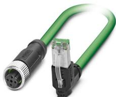
Câble de réseau, PROFINET CAT5 (100 Mbit/s), EtherCAT® CAT5 (100 Mbit/s), 4-pôles, Type de câble variable, blindé, Connecteur femelle droit M12, détrompage: D SPEEDCONNEC / IP67, sur connecteur mâle coudé RJ45 / IP20, longueur de câble: Longueur au choix (0,2... 40,0 m)
