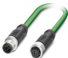
Câble de réseau, PROFINET CAT5 (100 Mbit/s), EtherCAT® CAT5 (100 Mbit/s), 4-pôles, blindé (Advanced Shielding Technology), connecteur mâle droit M12, détrompage: D / IP67, sur Connecteur femelle droit M12, détrompage: D / IP67, longueur de câble: 10 m
