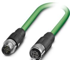
Câble de réseau, PROFINET CAT5 (100 Mbit/s), EtherCAT® CAT5 (100 Mbit/s), 4-pôles, Type de câble variable, blindé, connecteur mâle droit M12, détrompage: D SPEEDCONNEC / IP67, sur Connecteur femelle droit M12, détrompage: D SPEEDCONNEC / IP67, longueur de câble: Longueur au choix (0,2... 40,0 m)
