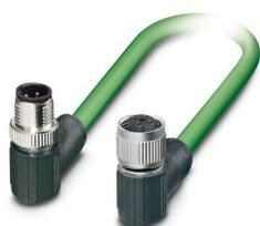
Câble de réseau, PROFINET CAT5 (100 Mbit/s), EtherCAT® CAT5 (100 Mbit/s), 4-pôles, Type de câble variable, blindé, connecteur mâle coudé M12, détrompage: D SPEEDCONNEC / IP67, sur Connecteur femelle coudé M12, détrompage: D SPEEDCONNEC / IP67, longueur de câble: Longueur au choix (0,2... 40,0 m)
