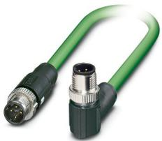
Câble de réseau, PROFINET CAT5 (100 Mbit/s), EtherCAT® CAT5 (100 Mbit/s), 4-pôles, Type de câble variable, blindé, connecteur mâle droit M12, détrompage: D SPEEDCONNEC / IP67, sur connecteur mâle coudé M12, détrompage: D SPEEDCONNEC / IP67, longueur de câble: Longueur au choix (0,2... 40,0 m)
