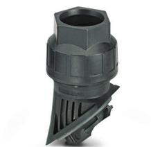
Presse-étoupe plastique EVO avec fermeture à baïonnette ; taille M40, pour 5 conducteurs avec diamètre de câble de 8,5 mm
