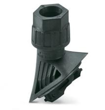
Presse-étoupe plastique EVO avec fermeture à baïonnette, pour boîtier de série B, taille M25, diamètre de câble 9 mm ... 17 mm
