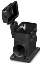
Embase en saillie B10, pour étrier transversal, matériau: PA, matériau du couvercle de protection: PC, nombre de sorties: 2, latérale, 2x M32, hauteur: 74 mm, presse-étoupe: sans, capot de protection: oui, Standard
