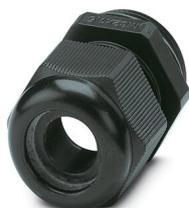
Raccordement vissé en plastique jusqu'à 5 bar, longueur fileté : 10 mm, diamètre câble : 16- 28 mm, SW 46, raccordement vissé : M40
