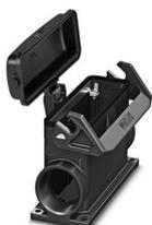
Embase en saillie B24, avec étrier longitudinal, matériau: PA, matériau du couvercle de protection: PC, nombre de sorties: 2, latérale, 2x M40, hauteur: 84 mm, presse-étoupe: sans, capot de protection: oui, Standard
