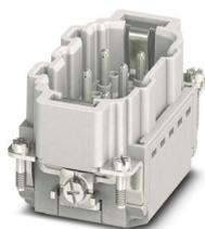
Élément de contact, nombre de pôles: 3+2+PE, taille: B10, contacts de puissance: 3, contacts de commande: 2, nombre de raccordements par pôle: 1, Mâle, Raccordement Push-in, 690 V, 16 A, 0,14 mm<sup>2</sup> ... 2,5 mm<sup>2</sup>, application: Puissance
