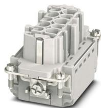
Élément de contact, nombre de pôles: 3+2+PE, taille: B10, contacts de puissance: 3, contacts de commande: 2, nombre de raccordements par pôle: 1, Connecteur femelle, Raccordement Push-in, 690 V, 16 A, 0,14 mm<sup>2</sup> ... 2,5 mm<sup>2</sup>, application: Puissance
