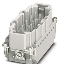
Élément de contact, nombre de pôles: 6+2+PE, taille: B16, contacts de puissance: 6, contacts de commande: 2, nombre de raccordements par pôle: 1, Mâle, Raccordement Push-in, 690 V, 16 A, 0,14 mm<sup>2</sup> ... 2,5 mm<sup>2</sup>, application: Puissance
