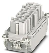
Élément de contact, nombre de pôles: 6+2+PE, taille: B16, contacts de puissance: 6, contacts de commande: 2, nombre de raccordements par pôle: 1, Connecteur femelle, Raccordement Push-in, 690 V, 16 A, 0,14 mm<sup>2</sup> ... 2,5 mm<sup>2</sup>, application: Puissance
