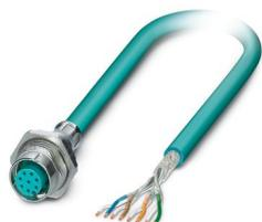
Connecteur d'appareil face arrière, Ethernet CAT5 (1 Gbit/s), 8-pôles, PUR, bleu lagon RAL 5021, Connecteur femelle encastrable droit M12 SPEEDCONNec, détrompage: A / IP67, sur extrémité libre, longueur de câble: 5 m, Produit de remplacement selon RoHS II sans exception 6c (Pb < 0,1 %) référence : 1238757
