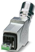
Connecteur RJ45, indice de protection: IP65/IP67, nombre de pôles: 8, 1 Gbit/s, CAT5, matériau: Métal, type de raccordement: Raccordement autodénudant IDC, section raccordable: AWG 26- 24, sortie du câble: coudé, Ethernet
