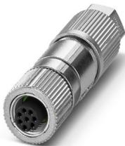
Connecteur de données, Ethernet CAT5 (1 Gbit/s), 8-pôles, exempt d'halogène, blindé, connecteur femelle droit M12, détrompage: A, Raccordement autodénudant, matériau de la molette: Zinc moulé sous pression, nickelé, diamètre extérieur du câble 5 mm ... 9,7 mm
