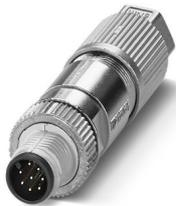
Connecteur de données, Ethernet CAT5 (1 Gbit/s), 8-pôles, exempt d'halogène, blindé, connecteur mâle droit M12, détrompage: A, Raccordement autodénudant, matériau de la molette: Zinc moulé sous pression, nickelé, diamètre extérieur du câble 5 mm ... 9,7 mm
