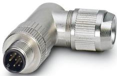
Connecteur de données, Ethernet CAT5 (1 Gbit/s), 8-pôles, blindé, connecteur mâle coudé M12, détrompage: A, Raccordement autodénudant, matériau de la molette: Laiton, nickelé, diamètre extérieur du câble 4 mm ... 8 mm
