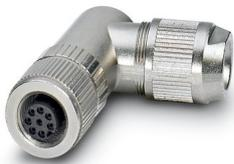
Connecteur de données, Ethernet CAT5 (1 Gbit/s), 8-pôles, blindé, connecteur femelle coudé M12, détrompage: A, Raccordement autodénudant, matériau de la molette: Laiton, nickelé, diamètre extérieur du câble 4 mm ... 8 mm
