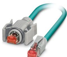
Câble Ethernet préconfectionné, blindé, à 4 paires, AWG 26 souple (7 fils), RAL 5021 (bleu d'eau), connecteur mâle RJ45/IP67, gris sur connecteur mâle RJ45/IP20, Line, longueur 5 m
