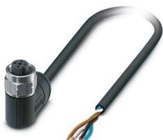
Câble pour capteurs/actionneurs, 4-pôles exempt d'halogène, extrémité libre, sur Connecteur femelle coudé M12, détrompage: A, longueur de câble: 10 m, pour applications extérieures, avec molette inox
