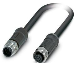
Câble pour capteurs/actionneurs, 8-pôles exempt d'halogène, blindé, connecteur mâle droit M12, détrompage: A, sur Connecteur femelle droit M12, détrompage: A, longueur de câble: 20 m, pour applications extérieures, avec molette inox
