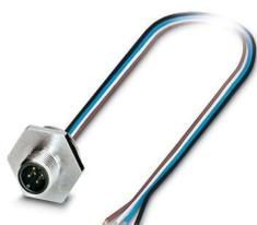
Embases paroi avant, Universel, 5-pôles, Connecteur mâle, droit, M12, détrompage: A, sur extrémité libre, Montage sur face avant, M20 x 1,5, Cordons individuels, longueur de câble: 0,5 m, 0,34 mm<sup>2</sup>, Cordon TPE, Produit de remplacement selon RoHS II sans exception 6c (Pb < 0,1 %) référence : 1238773
