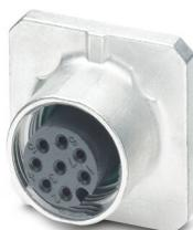
Embases paroi avant, Universel, 8-pôles, connecteur femelle, droit, M12-SPEEDCONNEC, détrompage: A, Montage sur face avant, Bride carrée, Soudage à la vague, 0,25 mm<sup>2</sup>, Produit de remplacement selon RoHS II sans exception 6c (Pb < 0,1 %) référence : 1238782
