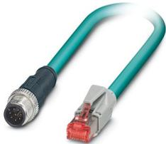
Câble de réseau, Ethernet CAT5 (1 Gbit/s), 8-pôles exempt d'halogène, blindé, connecteur mâle droit M12, détrompage: A / IP67, sur connecteur mâle droit RJ45 / IP20, longueur de câble: 0,5 m
