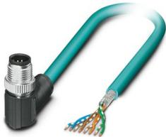
Câble de réseau, Ethernet CAT5 (1 Gbit/s), 8-pôles exempt d'halogène, blindé, connecteur mâle coudé M12, détrompage: A / IP67, sur extrémité libre, longueur de câble: 5 m
