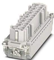
Élément de contact, nombre de pôles: 24+PE, taille: B24, nombre de raccordements par pôle: 1, Connecteur femelle, Raccordement Push-in, 500 V, 16 A, 0,14 mm<sup>2</sup> ... 2,5 mm<sup>2</sup>, application: Puissance
