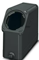
Capot passe-câble HEAVYCONNEC EVO en plastique, avec bride à baïonnette pour raccordement vissé EVO, B24, pour verrouillage longitudinal, hauteur 87,5 mm, sans raccordement vissé EVO
