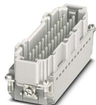
Élément de contact, nombre de pôles: 24+PE, taille: B24, nombre de raccordements par pôle: 1, Mâle, Raccordement Push-in, 500 V, 16 A, 0,14 mm<sup>2</sup> ... 2,5 mm<sup>2</sup>, application: Puissance
