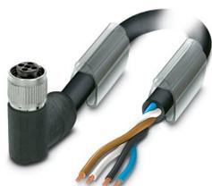
Conducteur de puissance, 4-pôles exempt d'halogène, extrémité libre, sur Connecteur femelle coudé M12, détrompage: T, longueur de câble: 2 m, pour courant continu jusqu'à 12 A/63 V
