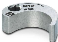
Embout pour le montage de câbles pour capteurs/actionneurs munis de connecteurs M12 et de connecteurs M12 à équiper avec diamètre d'écrou moleté de 16 mm, pour emmanchement à six pans de 4 mm
