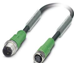
Câble pour capteurs/actionneurs, 3-pôles, PUR exempt d'halogène, gris-noir RAL 7021, connecteur mâle droit M12, détrompage: A, sur Connecteur femelle droit M8, longueur de câble: 0,3 m, Variante client
