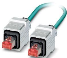
Câble Ethernet préconfectionné, CAT5e, blindé, 2 paires, AWG 26 flexible (7 fils), RAL 5021 (bleu d'eau), connecteur mâle RJ45/IP67 boîtier métallique Push-Pull sur connecteur mâle RJ45/IP67 boîtier métallique Push-Pull, Line, longueur : 10 m
