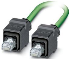
Câble PROFINET préconfectionné, CAT 5e, blindé, quarte en étoile, AWG 22 flexible (7 fils), RAL 6018 (jaune-vert), connecteur mâle RJ45/IP67 boîtier plastique Push-Pull sur connecteur mâle RJ45/IP67 boîtier plastique Push-Pull, Line, longueur : 5 m
