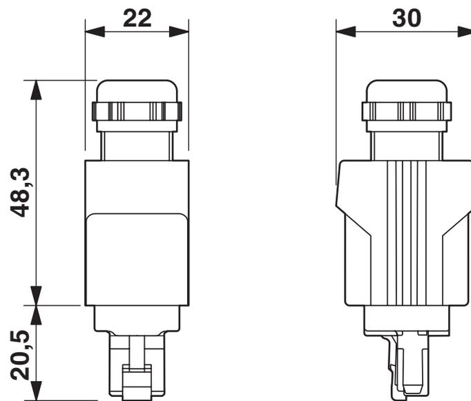
Connecteur mâle RJ45 Push-Pull, IP67
