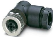
Connecteur de puissance, 4-pôles, non blindé, connecteur femelle coudé M12, T, Raccordement vissé, matériau de la molette: Zinc moulé sous pression, nickelé, presse-étoupe Pg11, diamètre extérieur du câble 8 mm ... 10 mm, pour courant continu jusqu'à 12 A/63 V
