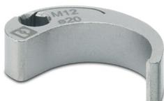
Embout enfichable pour le montage de connecteurs M12 à équiper avec diamètre d'écrou moleté transversal 20 mm, pour emmanchement à six pans de 4 mm
