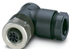
Connecteur de puissance, 4-pôles, connecteur femelle coudé M12, A, Raccordement vissé, matériau de la molette: Zinc moulé sous pression, nickelé, presse-étoupe Pg11, diamètre extérieur du câble 8 mm ... 10 mm
