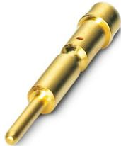
Contact à sertir, Famille d'articles: VARIOCON, section de fil min.: 0,14 mm<sup>2</sup>, section de fil max.: 0,5 mm<sup>2</sup>, Type de raccordement: Raccordement à sertir, Type de contact: Mâle. pour le SET HC-MOT-AFL
