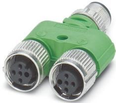
Répartiteur en Y, 5-pôles, connecteur mâle droit M12, détrompage: A SPEEDCONNEC, sur Connecteur femelle droit M12, détrompage: A SPEEDCONNEC, Broches 2+4 pontées et Connecteur femelle droit M12, détrompage: A SPEEDCONNEC, Broches 2+4 pontées, Connecteur femelle M12 fileté non pivotant
