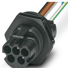
Connecteur d'appareil face arrière, Famille d'articles: PRC 35, matériau du boîtier: PPE, coloris: noir, nombre de pôles: 5, section de fil max.: 4 mm<sup>2</sup>, tension de référence: 690 V AC, courant de référence: 32 A, Type de raccordement: Raccordement à sertir, Type de contact: Mâle, longueur de câble: 150. Cet article est également disponible avec d'autres longueurs de câbles. Pour vos besoins, veuillez contacter votre filiale locale de PHOENIX CONTACT.
