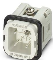
Élément de contact, nombre de pôles: 3+PE, taille: D7, nombre de raccordements par pôle: 1, Mâle, Raccordement vissé, 230 V/400 V, 10 A, 0,5 mm<sup>2</sup> ... 2,5 mm<sup>2</sup>
