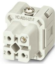
Élément de contact, nombre de pôles: 3+PE, taille: D7, nombre de raccordements par pôle: 1, Connecteur femelle, Raccordement vissé, 230 V/400 V, 10 A, 0,5 mm<sup>2</sup> ... 2,5 mm<sup>2</sup>
