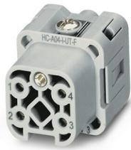
Élément de contact, nombre de pôles: 4+PE, taille: D7, nombre de raccordements par pôle: 1, Connecteur femelle, Raccordement vissé, 230 V/400 V, 10 A, 0,5 mm<sup>2</sup> ... 2,5 mm<sup>2</sup>
