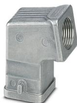
Capot passe-câble D7, pour étrier longitudinal, matériau: Aluminium coulé sous pression, résistant à l'eau de mer, nombre de sorties: 1, latérale, 1x M20, hauteur: 52,8 mm, presse-étoupe: sans, Standard
