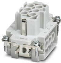
Élément de contact, nombre de pôles: 6+PE, taille: B6, nombre de raccordements par pôle: 1, Connecteur femelle, Raccordement vissé, 500 V, 16 A, 0,5 mm<sup>2</sup> ... 2,5 mm<sup>2</sup>, application: Puissance
