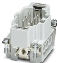
Élément de contact, nombre de pôles: 6+PE, taille: B6, nombre de raccordements par pôle: 1, Mâle, Raccordement vissé, 500 V, 16 A, 0,5 mm<sup>2</sup> ... 2,5 mm<sup>2</sup>, application: Puissance
