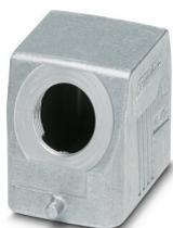
Capot passe-câble B6, pour étrier longitudinal, matériau: Aluminium coulé sous pression, résistant à l'eau de mer, nombre de sorties: 1, latérale, 1x M20, hauteur: 52 mm, presse-étoupe: sans, Standard
