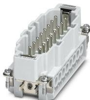
Élément de contact, nombre de pôles: 16+PE, taille: B16, nombre de raccordements par pôle: 1, Mâle, Raccordement vissé, 500 V, 16 A, 0,5 mm<sup>2</sup> ... 2,5 mm<sup>2</sup>, application: Puissance
