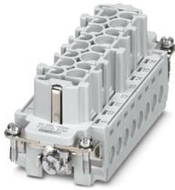
Élément de contact, nombre de pôles: 16+PE, taille: B16, nombre de raccordements par pôle: 1, Connecteur femelle, Raccordement vissé, 500 V, 20 A, 0,5 mm<sup>2</sup> ... 2,5 mm<sup>2</sup>, application: Puissance
