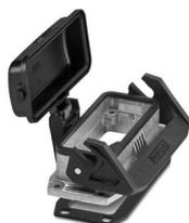
Embase B16, avec étrier longitudinal, matériau: Aluminium coulé sous pression, résistant à l'eau de mer, matériau du couvercle de protection: PC, hauteur: 30,5 mm, presse-étoupe: sans, capot de protection: oui, Standard, avec joint plat
