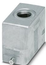
Capot passe-câble B16, pour étrier longitudinal, matériau: Aluminium coulé sous pression, résistant à l'eau de mer, nombre de sorties: 1, droit, 1x M25, hauteur: 60 mm, presse-étoupe: sans, Standard
